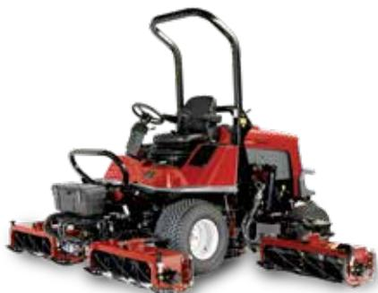
Hochleistungsmäher T4240 mit 5 Schneideeinheiten
